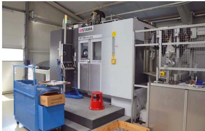
Die MT 733 one plus mit Gegenfutter für die 6-Seiten-Komplettbearbeitung. Bild: Konradin/Rindle
